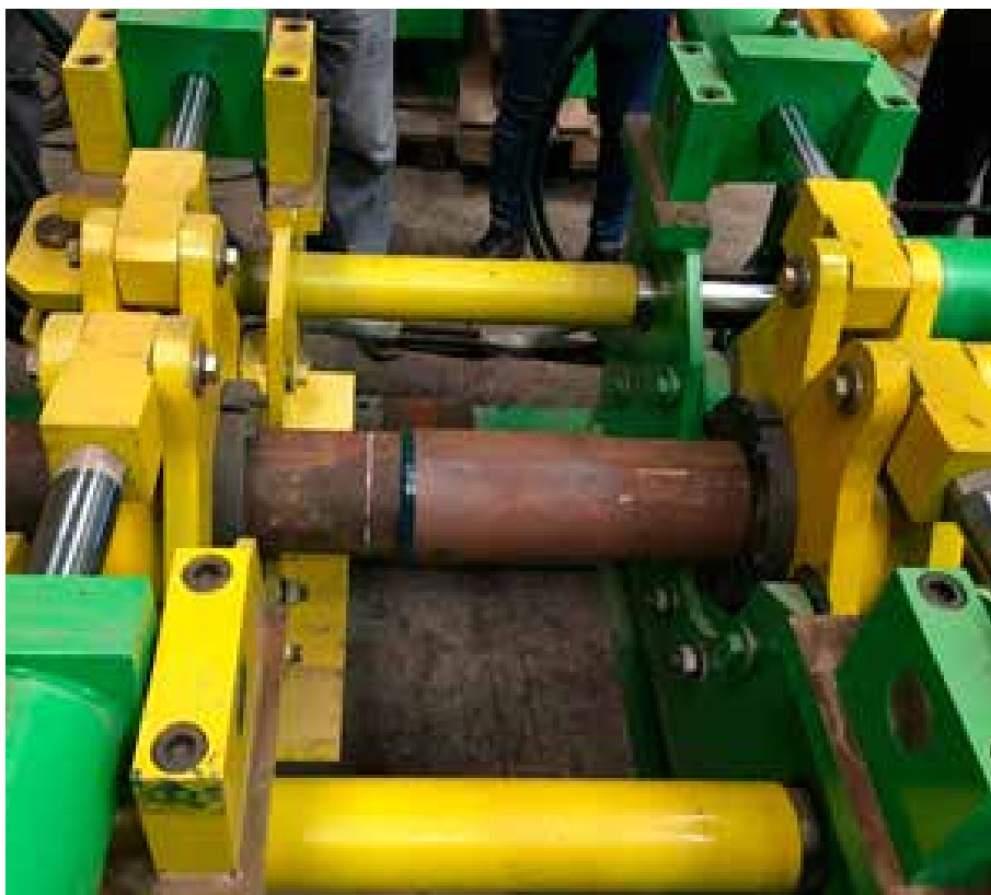
FIGURA 6 PRENSA HIDRÁULICA DENOMINADA "ENHEBRADORA", PARA UNIONES EN CAMPO.
